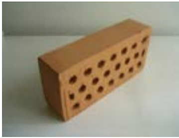
Figura 17.2 Esempio di mattone semipieno 15\% < f \leq 45\% in laterizio per murature portanti (fonte: www.fornacetrezzo.it )
